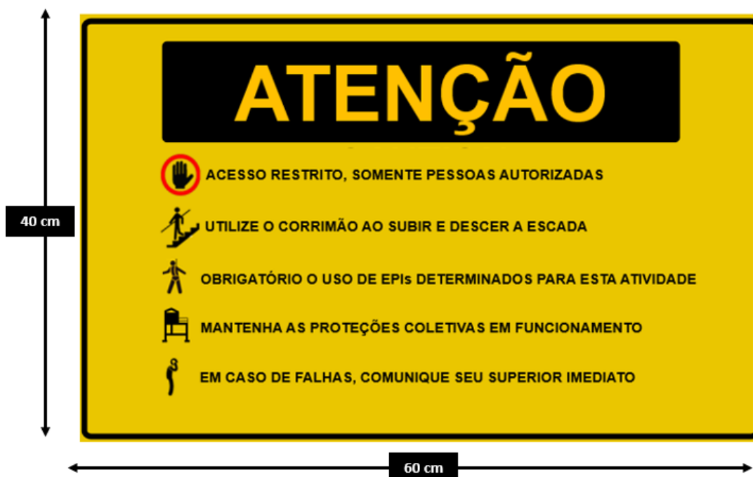
Figura 3 - Ilustração de sinalização de segurança nas plataformas de trabalho em altura ao lado da escada de acesso
