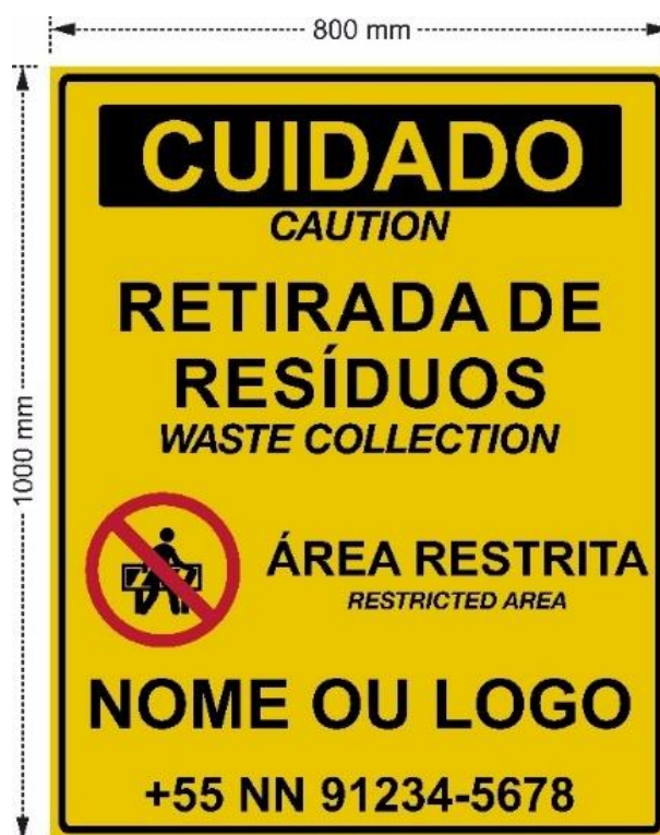
Figura 1 – Esquema ilustrativo da placa de identificação de serviço em retiradas de resíduos de embarcações.
